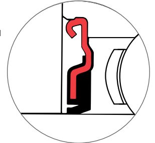
Однокромочное (стандартное) уплотнение
