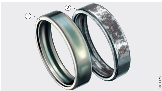
Рисунок 11 Кольца подшипников после испытания в солевом тумане
