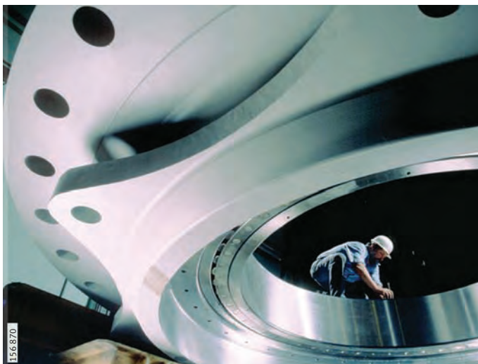
Рисунок 5 Монтаж крупногабаритного подшипника качения
