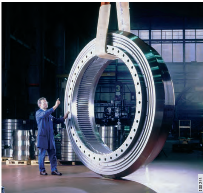
Рисунок 13 Комбинированные цилиндрические роликоподшипники с интегрированным зубчатым венцом
