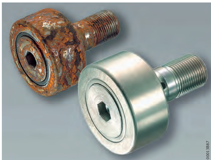
Рисунок 25 Опорный ролик с цапфой с защитным покрытием и без после испытания в солевом тумане
