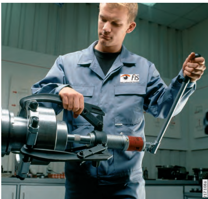
Рисунок 1 Демонтаж подшипника с помощью гидравлического съемника
